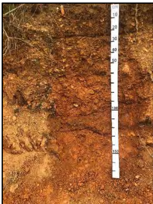
FOTO 4.1.3.5 – Perfil típico de Argissolo Vermelho Amarelo concrecionário ocorrente na região, apresentando horizonte A pouco desenvolvido, e horizontes Bt1, Bt2 e Bt3 com aumento progressivo de argila.
