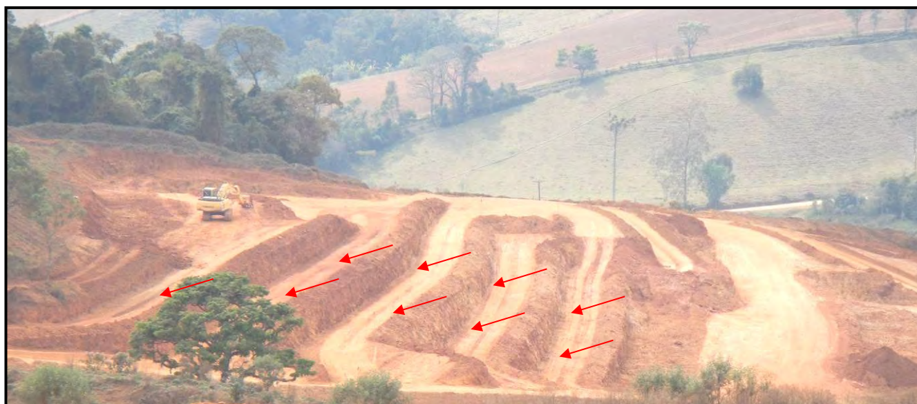
FOTO 5.1.1.1 – Detalhe de mina de minério de alumínio (bauxita) da CGM, na qual se observa a inclinação das bermas em direção ao “pé” dos taludes, possibilitando o disciplinamento das águas pluviais.
