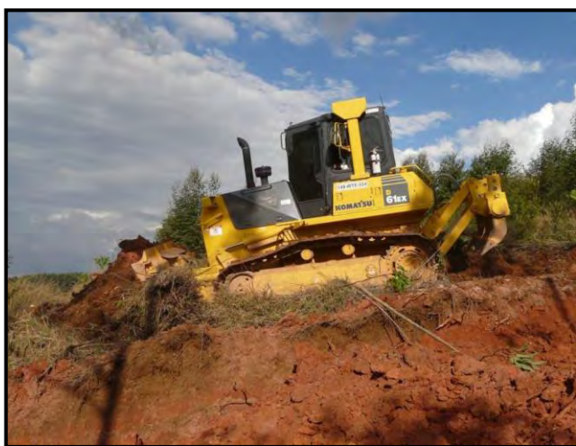
FOTO 3.1.11 – Trator Komatsu D61 realizando as atividades de decapeamento nas áreas de extração de minério de alumínio (bauxita).
