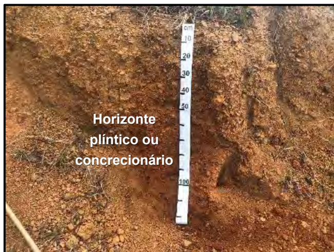
FOTO 4.1.3.7 – Perfil de solo local, localizado em antiga área de extração de bauxita, com presença de um horizonte plíntico que caracteriza o Plintossolo Pétrico (FF) que ocorre associado ao Argissolo Vermelho Amarelo (PVA).
